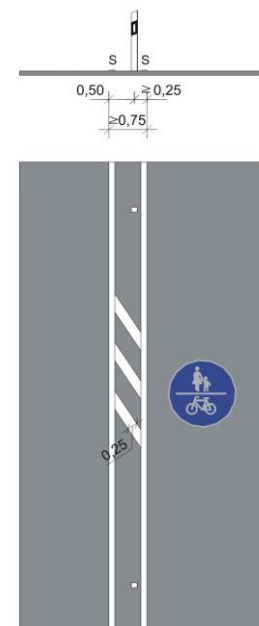
Abb. 17: Standardlösung des Trennstreifens auf Streckenabschnitten
